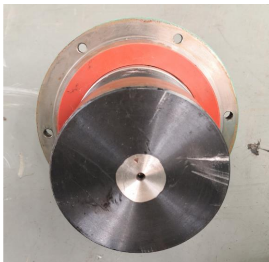
600 次手动松闸试验后的铁芯端面
