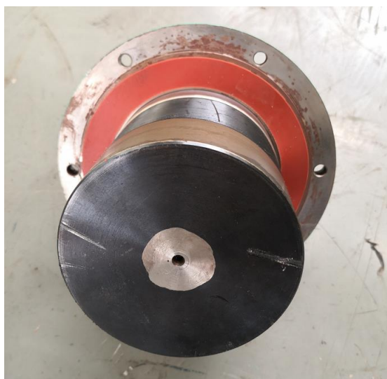
600 次手动松闸试验后的铁芯端面
